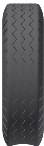
Falta de pressão
